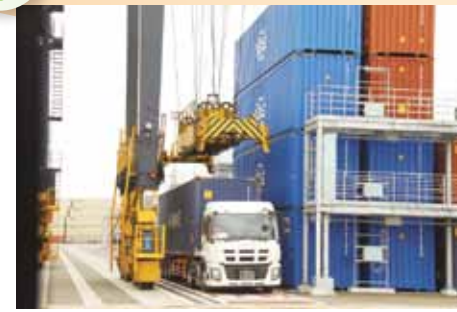
トランスファークレーンでコンテナをトレーラーに移す
