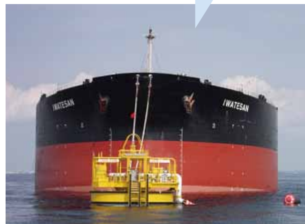
KKSBに着標中のVLCC。 2本の係留索は、直径155mm、長さ46m、 先端に本船連結用のチェーン付き。
