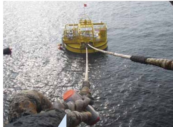
KKSBに着標中のVLCC。 2本の係留索は、直径155mm、長さ46m、 先端に本船連結用のチェーン付き。
