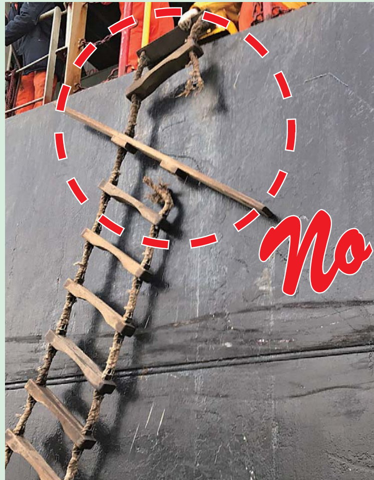
水先人乗船中にサイドロープが切断した。 パイロットラダーの整備不良であった。 (SOLAS違反)
